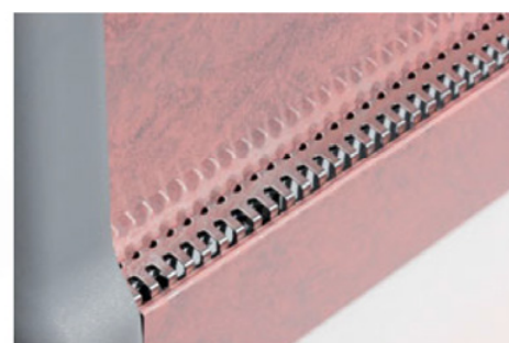
Ventilace zabraňující mlžení čelního skla
