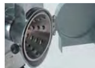
Stożek do ścierania mozzarelli (otwory 7 mm)
